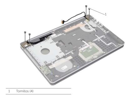
**13** Levante el reposamanos del ensamblaje de la pantalla.
