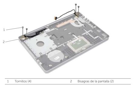
3 Levante el reposamanos del ensamblaje de la pantalla.
