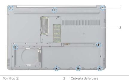
**3** Haga palanca y retire la cubierta de la base del equipo.
