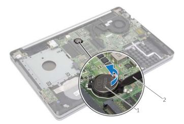
1 Batería de tipo botón 2 Punta trazadora de plástico
