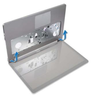
**15** Deslice y levante el ensamblaje del reposamanos para liberar el ensamblaje de la pantalla.
